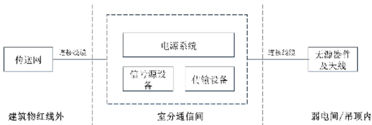
图 2 无线室内分布系统示意图
