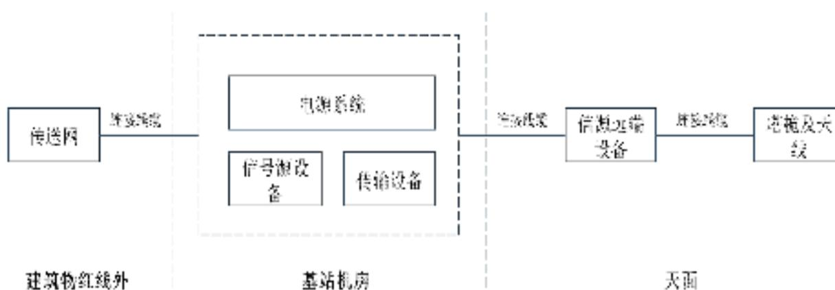
图 1 移动通信基站系统示意图
